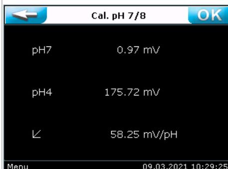
Am Ende der pH- Justierung werden die Messergebnisse der Nullpunktspannung pH7, der Steilheitsspannung pH4 und die daraus ermittelte Steilheit in mV/pH angezeigt. Diese drei Werte werden beurteilt und entsprechend farblich dargestellt.
