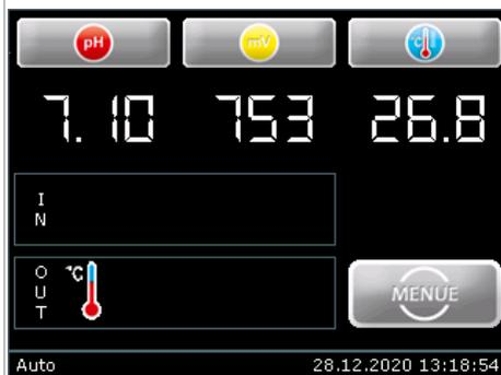
Das Gerät befindet sich im Status **Auto** (Automatik- Modus).
