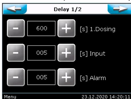
**1.Dosing** → Erst nach Ablauf dieser Zeit wird die Dosierung freigegeben Die Dosierverzögerung **1. Dosing** startet nach dem Einschalten bzw. nach Beendigung des Hauptmenüs.
