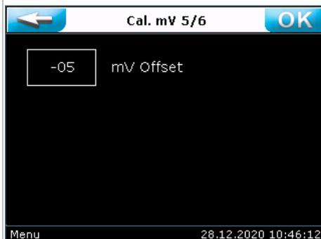
Am Menü- Ende wird die eingestellte Abweichung als Offset angezeigt.
