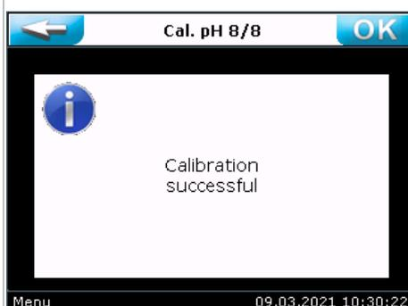
Eine erfolgreiche Justierung wird bestätigt. Anschließend wird der Anzeigewert anhand der neu ermittelten Elektrodencharakteristik berechnet und zur Anzeige gebracht.
