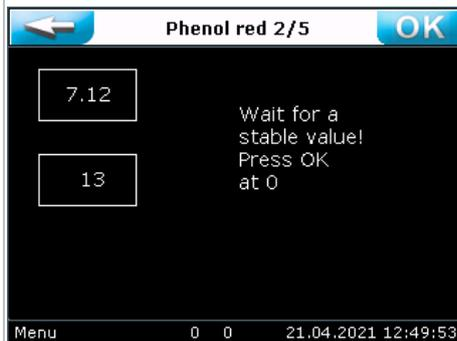
Stabile Messwerte sind für eine Justierung unerlässlich. Erst am nach Ablauf des Countdown bei 0 kann die Justierung mit der OK- Taste quittiert werden.
