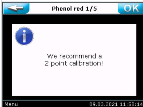
Das Menü **Phenol red** dient zur Anpassung des pH- Istwertes an eine manuell vorgenommene Referenzmessung.
