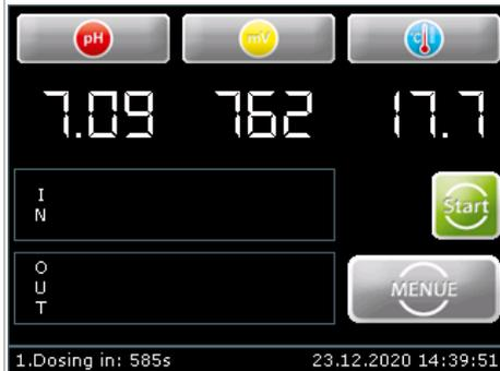
Wird das Gerät neu gestartet, bzw. das Hauptmenü beendet, so läuft die Dosiervverzögerung **1.Dosing in x s** ab. Während der Dosiervverzögerung erfolgt keine Dosierung.
