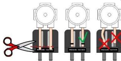
Die Schläuche der neuen Dosierkassetten entsprechend kürzen und auf die Schlauchnippel aufschieben. Anschließend mit den schwarzen Schlauchbindern fixieren. Abschließend die Dosierkassette wieder bis zum Einrasten auf die Motorwelle schieben.
