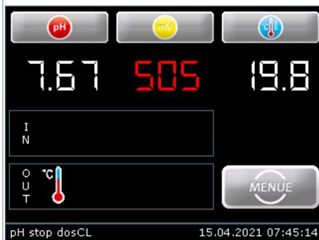
Nach einer Neubefüllung mit Frischwasser befindet sich der pH- Wert in der Regel über den empfohlenen pH-Werten von 7.0 bis 7.4
