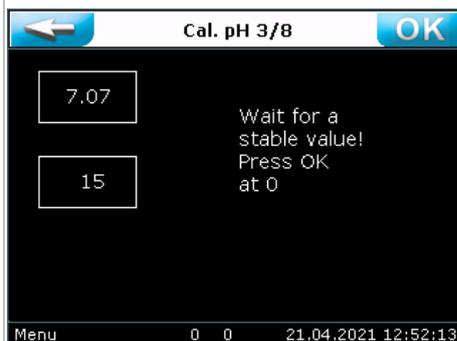
Stabile Messwerte sind für eine Justierung unerlässlich. Warten sie mit der Quittierung der OK Taste bis sich der Messwert stabilisiert hat.
