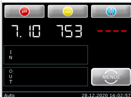
Wird bei der Temperatur anstelle einer Zahl **---** dargestellt, so liegt eine Störung der Temperaturmessung vor.
