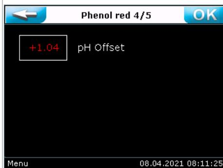
Bei einem Offset größer  $\pm 1,00$  pH wird der Wert **rot** eingefärbt.
