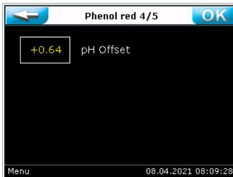
Bei einem Offset größer  $\pm 0.60$  pH wird der Wert **gelb** eingefärbt.
