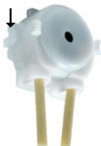
Im Rahmen einer jährlichen Wartung sollten die beiden Dosierkassetten getauscht werden. Hierzu die beiden seitlichen Spreizlaschen zusammendrücken und die Kassette nach vorne von der Motorwelle abziehen. Die beiden schwarzen Schlauchbinder am Schlauchende abwickeln und die Schläuche von den Schlauchnippeln abziehen.
