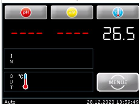
Wird anstelle der beiden Messwerte pH und mV **---** dargestellt, so liegt eine Störung am Messverstärker vor.
