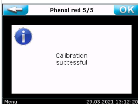
Eine erfolgreiche Justierung wird bestätigt. Anschließend wird der Anzeigewert anhand der Änderungsdifferenz neu berechnet und zur Anzeige gebracht.
