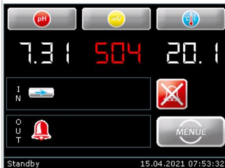
Liegt eine Störung vor oder ist ein Alarm eingetreten, so wird dies durch ein Symbol in der OUT- Zeile signalisiert. Das Alarmrelais ist aktiviert.
