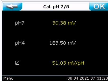
Bei einer Nullpunktspannung pH7 größer  $\pm 61$  mV wird der Wert **gelb** eingefärbt.
