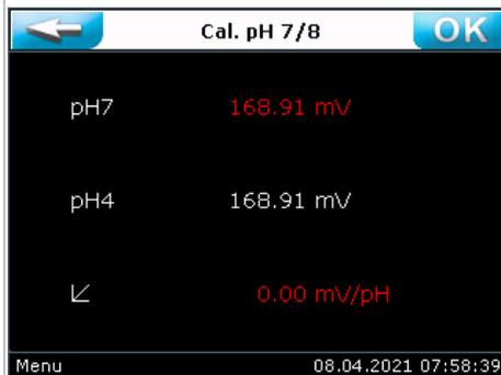
Bei einer Nullpunktspannung pH7 größer  $\pm 91$  mV wird der Wert **rot** eingefärbt.
